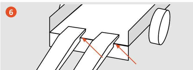
**Achten Sie darauf, dass die Safety Ramps bis zum Anschlag auf der Ladefläche aufliegen!**
