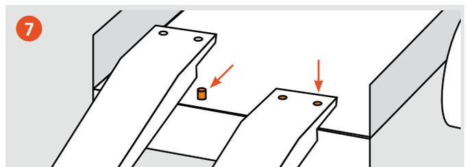
**Sichern Sie die Safety Ramps beim Be- und Entladen gegen Abrutschen!**
